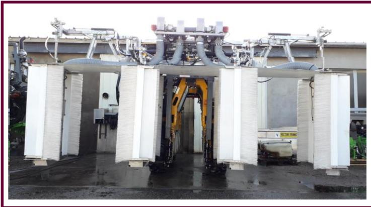
Système de panneaux récupérateurs avec confinement pour rampe de traitement GUYARD équipée de tous types de descentes face par face.
